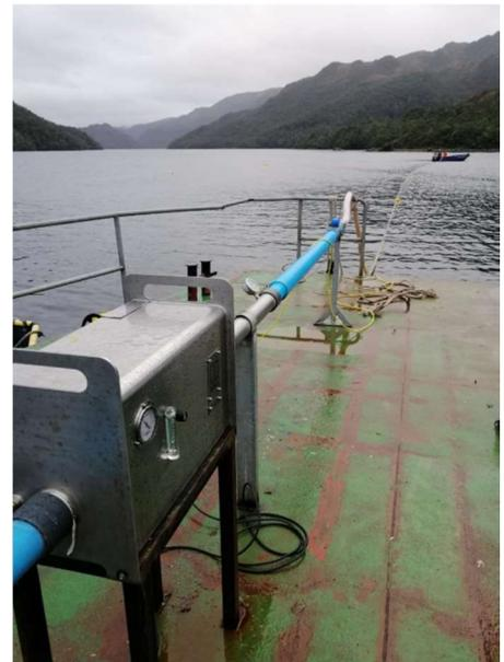
OKノズルを搭載したFB発生装置：KРАН 製
