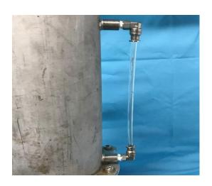
② 全てのバルブ(タンクに付いているエアー供給ホースのスロットルバルブ・ 水の出る2つの配管のバルブ)を閉めます。
