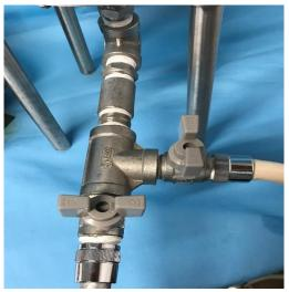
③ ポンプを作動させて水(液体)を送ります。 タンク内の水位(タンク横に付いているホースで確認)、又は水圧(加圧タン クについている圧力計で確認)が一定になれば、ノズルが付いている側のバ ルブを開けてください。
